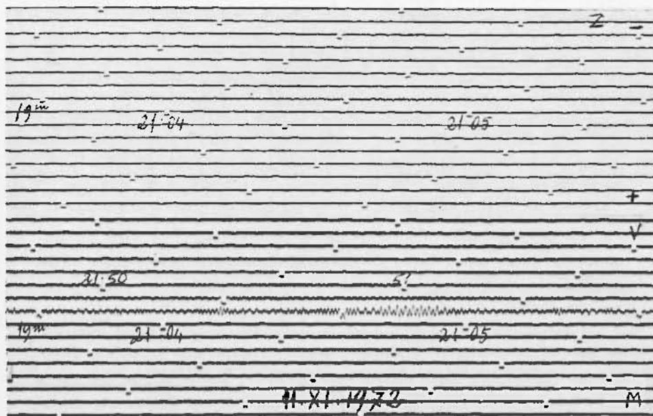
Fig. 5 - Microsisimi di carattere locale, registrati nella diga di Pieve di Cadore, durante il transito di disturbi microbarici sul lago limitrofo. [La comp. VM (valle-monte) ingrandisce circa i 3/4 di quella verticale]. Essi sono di carattere essenzialmente *longitudinale*, si spiegano teoricamente come « frange » delle onde di Rayleigh, e interessano la sola zona origine, conformemente alla teoria di Lamb.
