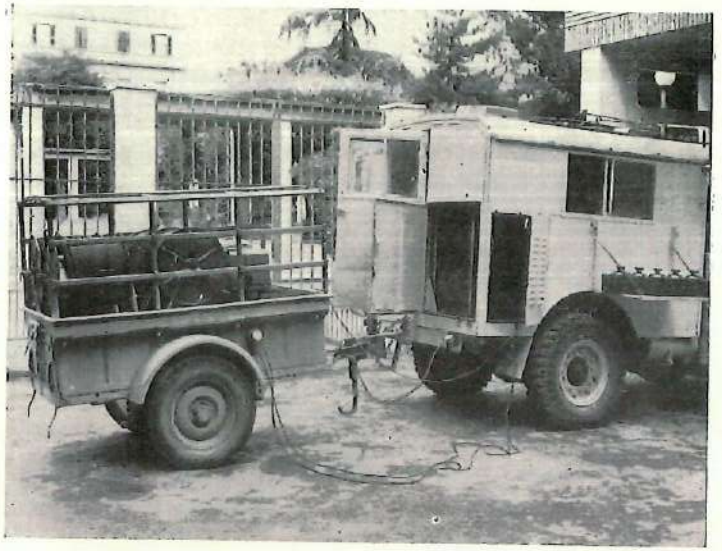
Autocarro attrezzato per rilevamenti geoelettrici.
