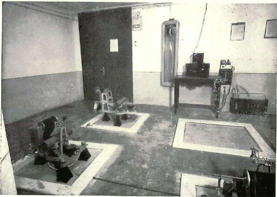
Stazione sismica di Tolmezzo con gruppo di sismografi a breve periodo costruiti dall'I.N.G.
