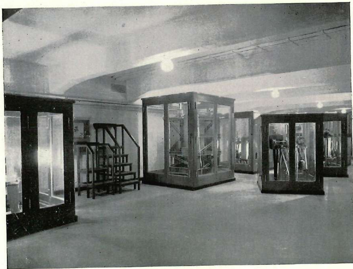
Sede centrale - Stazione sismica di Roma (complesso di nove sismografi a registrazione meccanica e fotografica).
