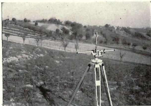
Corinaldo - Misure magnetiche assolute. (Componente orizzontale con teodolite da campo Askania).
