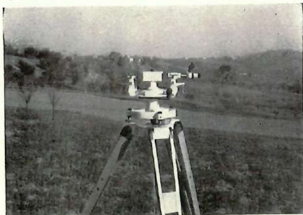
Corinaldo - Misure magnetiche assolute. (Declinazione con teodolite Askania).
